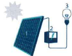
1. Zonnepaneel | 2. Omvormer 3. Elektrische toestellen
